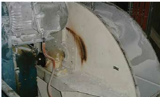
Hot spot (bruine lijn) op de kop van een emmerelevator: krachtige ontstekingsbron
